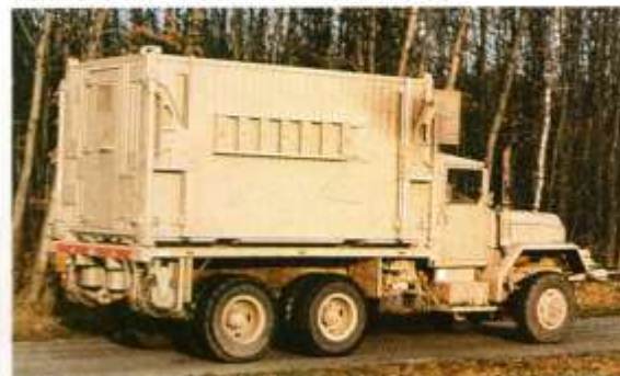
EQUIPEMENT PORTE SHELTER
