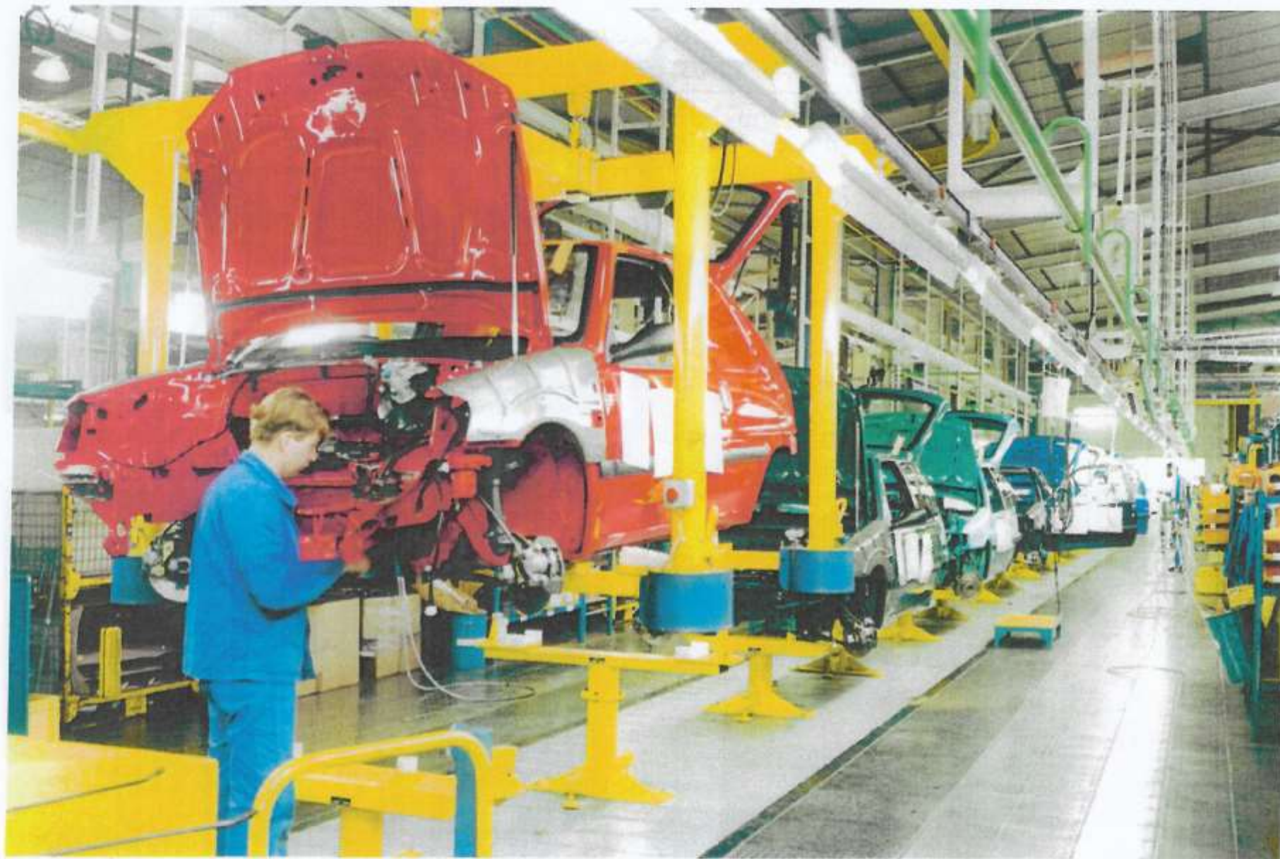
Ligne de montage Véhicules Electriques CITROËN Saxo et AX - PEUGEOT 106
